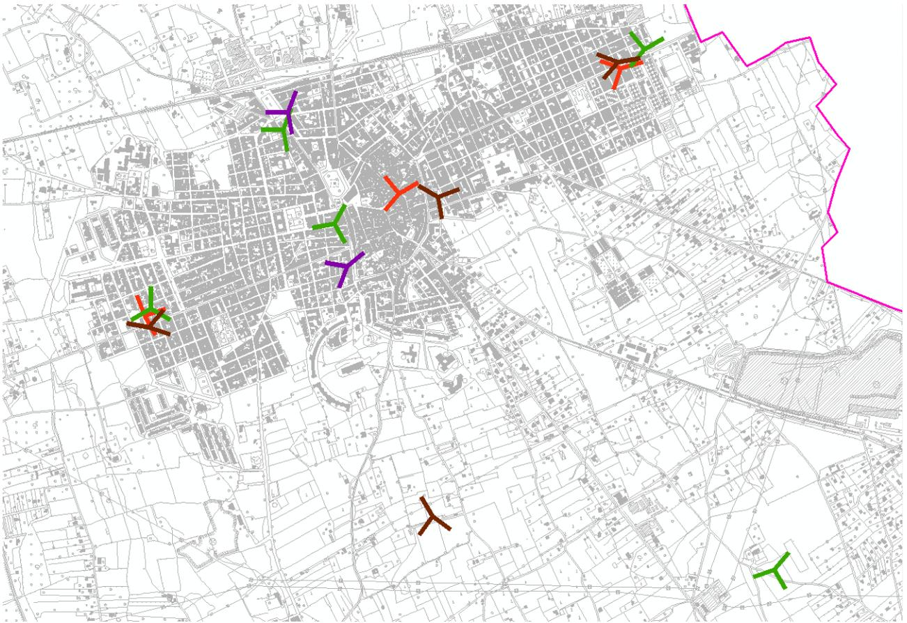
Una volta georeferenziate le SRB, orientate le singole celle che le compongono, si è passati alla misurazione dinamica del campo elettromagnetico esistente sul territorio comunale.
